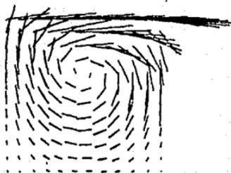
fig. 5.26 Descripción del campo de velocidades para el flujo en una cavidad cuadrada, con  $\mu=1.0$ ,  $N=144$ ,  $NELLE=338$
