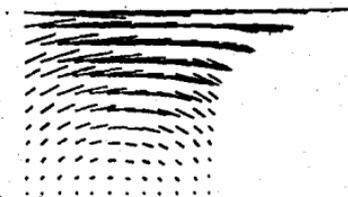
fig. 5.27 Descripción del campo de velocidades para el flujo en una cavidad cuadrada, con  $\mu=10.0$ ,  $N=144$ ,  $NELLE=338$
