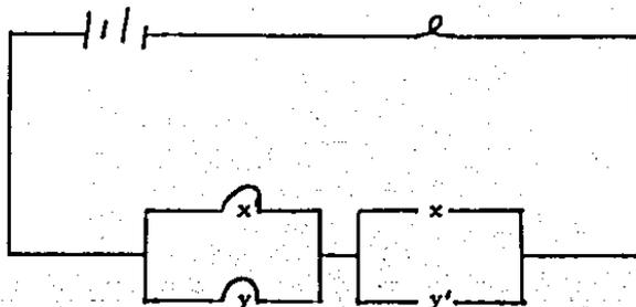
El circuito está ABIERTO y corresponde a la bicondicional. Por tanto, el foco permanece apagado.
