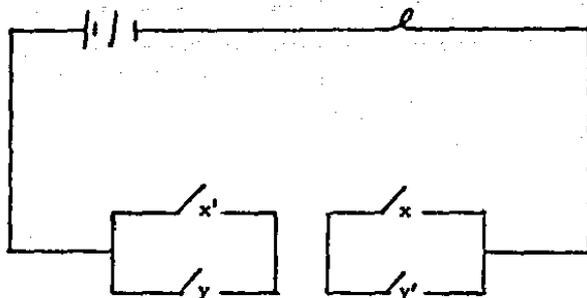
CIRCUITO LOGICO EN SERIE DE DOS CIRCUITOS EN PARALELO REPRESENTADO POR LA BICONDICIONAL Y SU RESPECTIVA EQUIVALENCIA.
