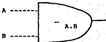
Si hay impulso en todas sus entradas entonces se produce como salida un impulso (1) como se muestra en la tabla.
