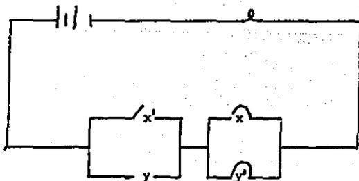
El circuito está ABIERTO y corresponde a la bicondicional. Por tanto, el foco permanece apagado.
