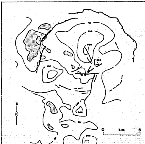
FIGURA 2.12 Contornos simplificados de iso-resistividad aparente (ohm-m) en el centro volcánico de La Primavera. Para una semiapertura entre electrodos (AB/2) de 1500 m (Ramero y Reyes, 1980). Bajos resistivos definidos por el contorno de 20 ohm-m; puntado fino: perforaciones profundas; líneas gruesas: fallas (discontinuas donde solo son inferidas).
