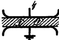
FIGURA 2 Descarga parcial interna.
