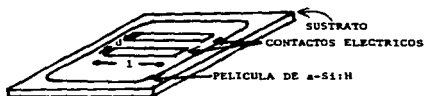
Fig. II.1.1 Sustrato de vidrio con una película de a-Si:H mostrando contactos eléctricos en geometría coplanar.
