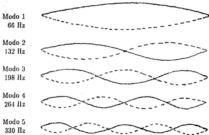
Figura 6. Modos de vibración de una cuerda afinada en  $C_2$  (66 Hz).
