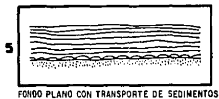
Fig. 2.24. Formas del fondo y su correspondiente estructura cinemática, según Znamenskaya (1962).
