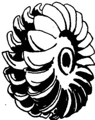
Fig. 2.1. Turbina de impulso tangencial.
