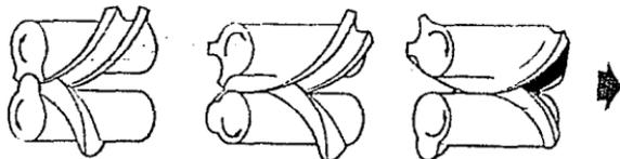
LOS COMPRESORES DE TORNILLO DE TIPO SECO UTILIZAN ENGRANAJES DE SINCRONIZACION EXTERNOS PARA LOS ROTORES MACHO Y HEMBRA. AL NO HABER CONTACTO ENTRE LOS ROTORES NI ENTRE ESTOS Y LA CARCAZA, NO SE NECESITA NINGUN TIPO DE LUBRICACION DENTRO DE LA CAMARA DE COMPRESION.
