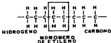
Fig. 2.11 Estructura de los materiales poliméricos.
