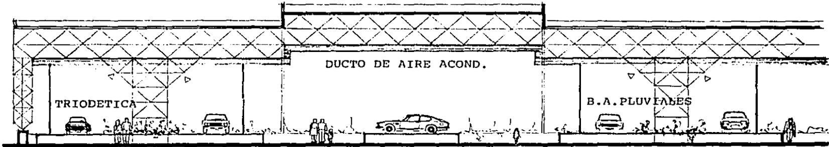
En el resto del conjunto se usar3; sistema constructivo de esqueleto, muros divisorios y cubiertas prefabricadas , seg3n las necesidades y conveniencias.
