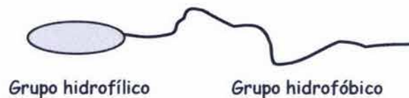
Fig. 3.1. Esquematación de la estructura de un tensoactivo
