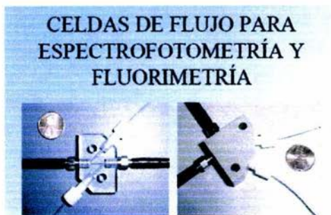
Figura 15. Celda de Peek. (Zona de detección)
