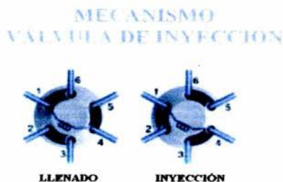
Figura 12. La figura muestra el mecanismo de acción de la válvula de inyección en sus dos posiciones de carga o llenado y de inyección.
