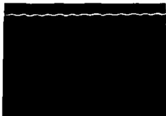
Fig. 3.1. Medición de +15 volts de la fuente de alimentación del sistema. Cada división representa 2 volts.
