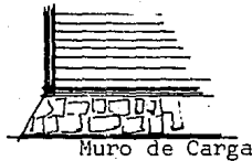
Muro de Carga
