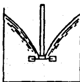
TURBINA DE DISCO DE HOJAS PLANAS
