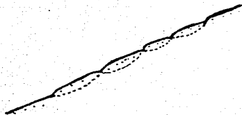
c) Fallas sucesivas.
