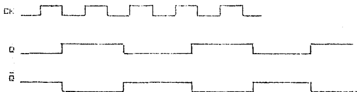
Fig. 8.21 Diagrama de tiempos de las salidas del flip-flop T.
