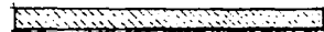
Sandwich de Pamacon y styropor, para lograr capas con distintos materiales aislantes
