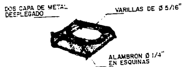
ARMADO DEL LAVABO
