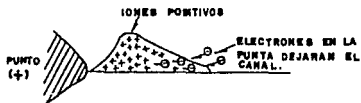
A) DENSIDAD DE IONES EN UN CANAL CORONA POSITIVO DURANTE LA PROPAGACION.
