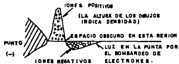
A) LA DENSIDAD DE IONES EN UN CORONA NEGATIVO ROMPE EN LAS PRIMERAS ETAPAS.
