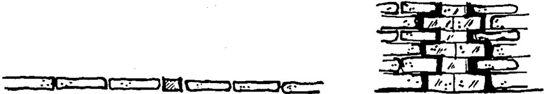
FIGURA 24. REFUERZOS VERTICALES A LO LARGO DE LOS MUROS
