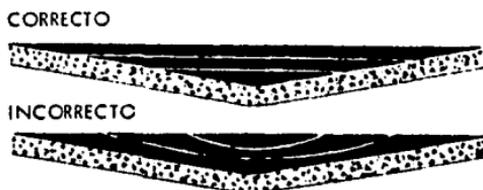
Figura V-1 Las cuñas de nivelación colocadas correctamente aseguran un pavimento liso.
