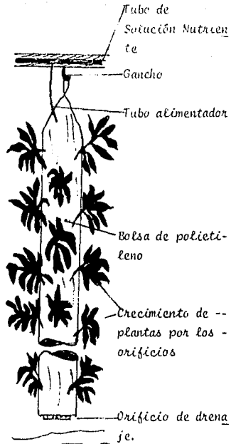
Figura 24. Esquema del sistema de cultivo en bolsa "colgante".
