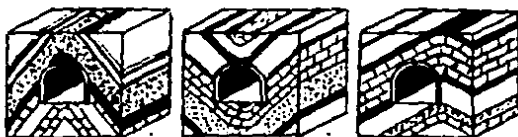
Figura 2.3 Túneles situados en anticlinales y sinclinales
