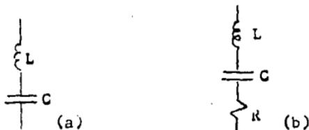
FIG. 3.17. Trampa con circuito resonante serie.
