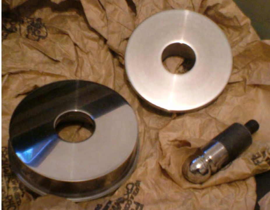
Fig. 3.9. Aspecto de los dados y el punzón pulidos a espejo
