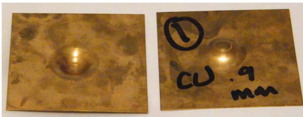
Fig. 4.2. Aspecto de las muestras de cobre de 0.9 mm después del ensayo.
