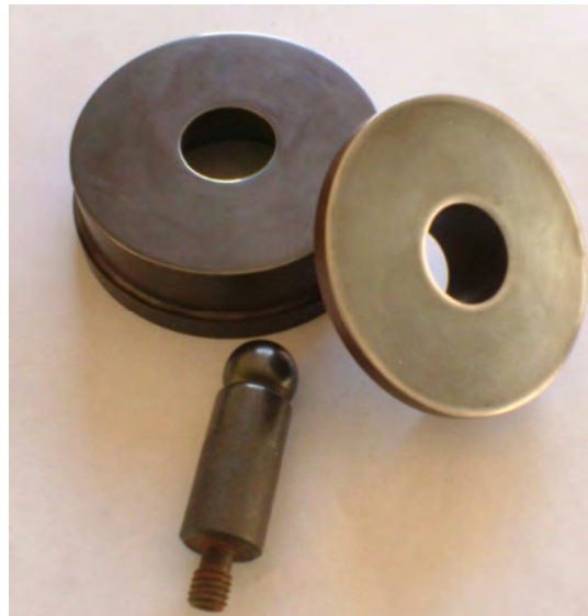
Fig. 3.10. Dados y punzón posteriores a la nitruración.
