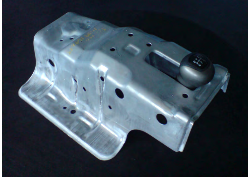
Fig. 2.6. Lámina estampada que aloja el sistema de la palanca de velocidades de un vehículo Nissan. Fotografiado con la autorización por Benteler de México S.A.
