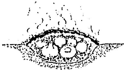
478. Horno primitivo de excavación poco profunda.
