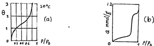
Figura 4. Isotermas de adsorción para : a) Benceno en: hollín grafitado b) Benceno en gel de sílice (poro grande)
