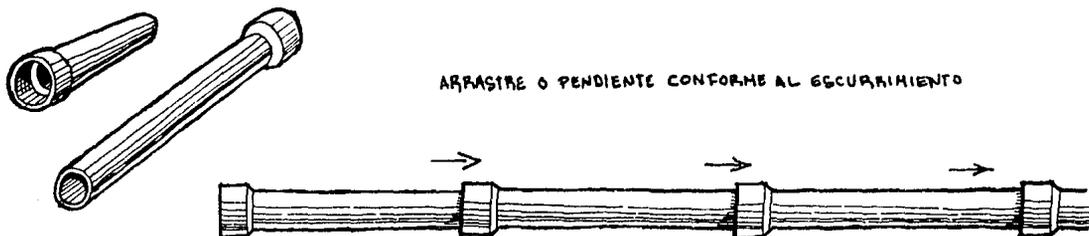
Para la colocación de los tubos se hará de la siguiente manera. Colocando la boca con la campana en -- contra de la corriente de los líquidos o aguas negras a desaguar. Y se acostillan con grava procurando dejar la parte de las campanas libre para que quede bien acentado el tubo. Al hacer esta operación deberá alinearse los tubos con un reventón a eje del tubo para proceder a juntarlos con mezcla.
