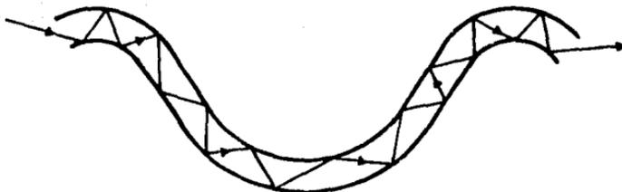
FIG. A-6 PRINCIPIO DE FUNCIONAMIENTO DE UNA FIBRA OPTICA
