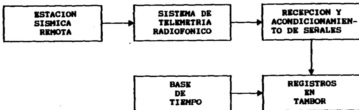
fig 2.2 Sistema de telemetría sísmica
