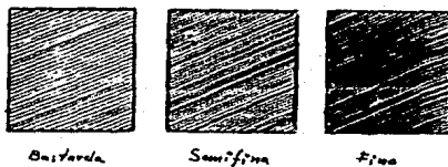
Fig. 79.- Tipos de dientes para limas de picado sencillo.
