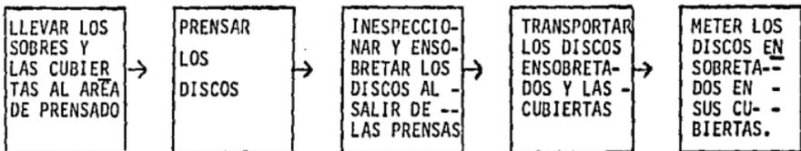
INSPECCION 100% visual, muestra del 3% para inspección auditiva; - la mayor parte de los defectos se detectan aquí.
