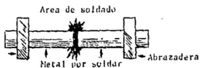
Figura 6. Soldadura a tope.
