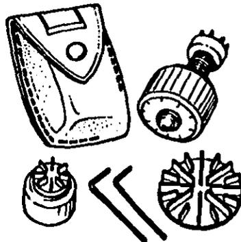
Fig 9. Torcómetro para medir resistencia no drenada de suelos blandos (13)
