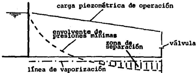
c) Sistema con válvula aguas abajo
