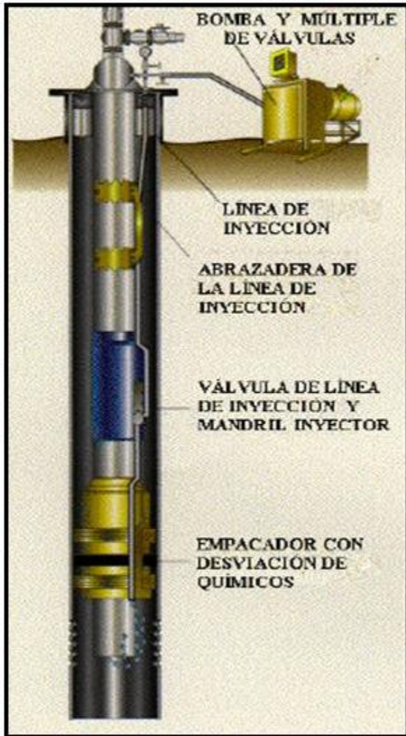
fig.IV.7 Sistema de inyección continua de productos químicos
