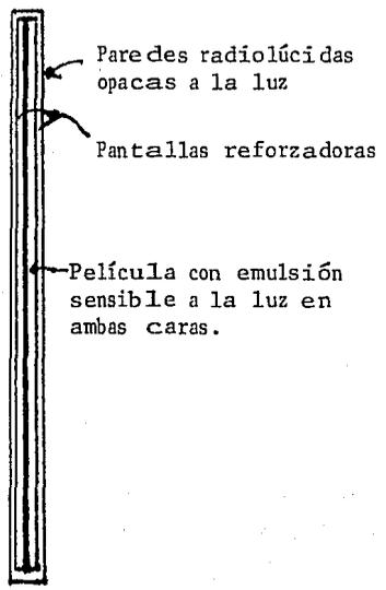
Fig. 2. Sección transversal de un chasis. Empleando un chasis con pantallas reforzadoras, reduciendo así el tiempo de exposición de la película. Es una caja a prueba de luz en la que se puede acomodar una placa radiográfica de 20 cm x 25 cm.
