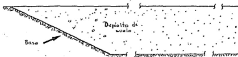
Fig. 1 Esquema de un depósito de suelo sobre una base inclinada de roca.
