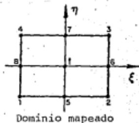
Fig. 13 Mapeo isoparamétrico.
