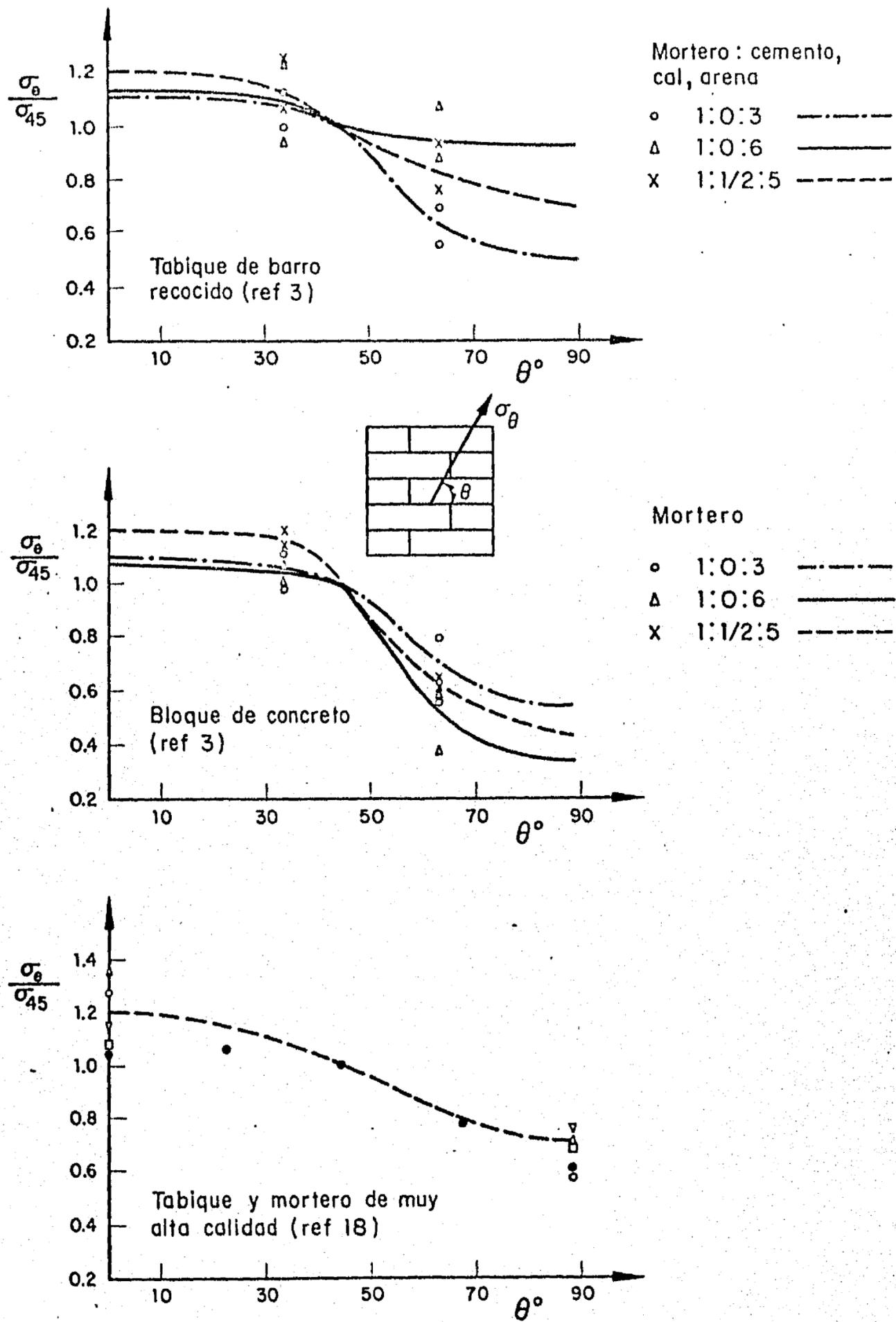
Fig 12. Variación de la resistencia a tensión de distintos tipos de mampostería
