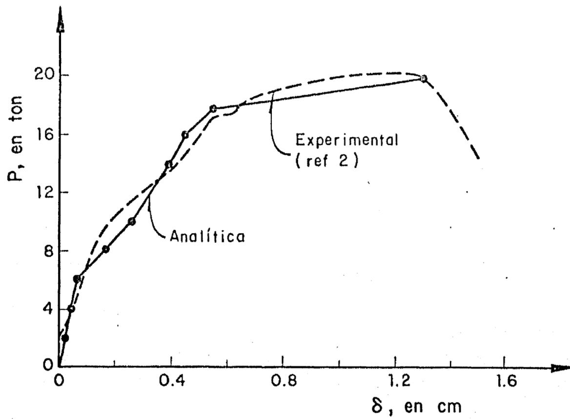
Fig 30. Curvas carga – desplazamiento lateral para el muro de la fig 26
