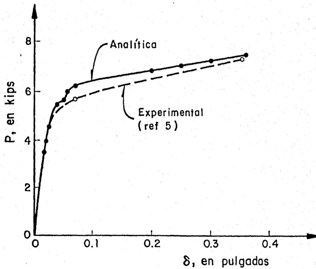
Fig 25. Curvas carga - desplazamiento lateral para el muro de la fig 22
