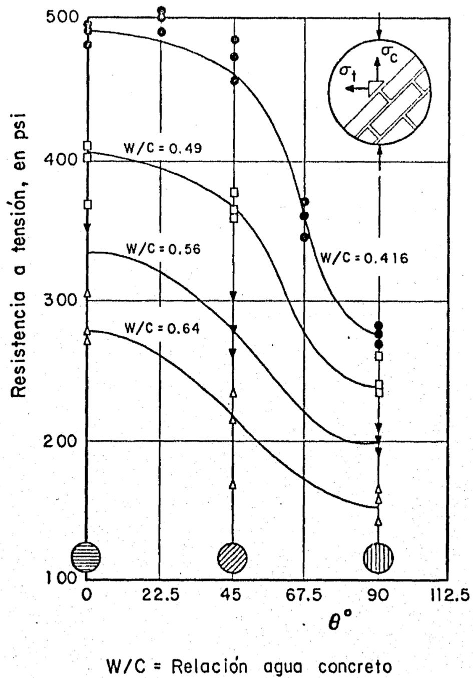
Fig 4. Variación de la resistencia a tensión de discos de mampostería con la dirección de los esfuerzos (ref 18)
