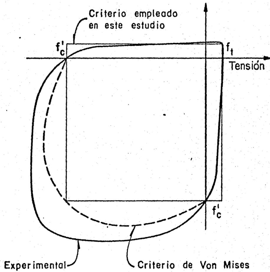
Fig 2. Resistencia del concreto ante estados biaxiales de esfuerzos (ref 13)
