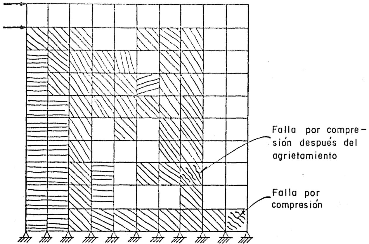
Fig 32. Configuración de falla obtenida analíticamente para el muro de la fig 31
