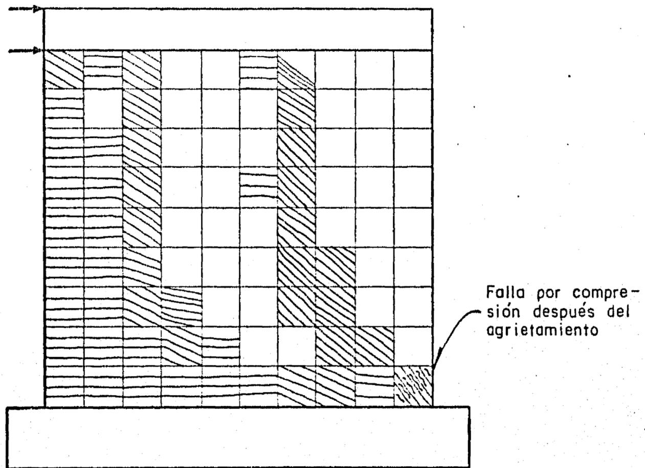
Fig 28. Configuración de falla obtenida analíticamente para el muro de la fig 26
