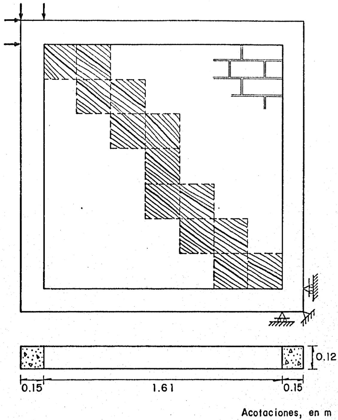
Fig 13. Agrietamiento de un muro confinado por castillos, sujeto a compresión diagonal
