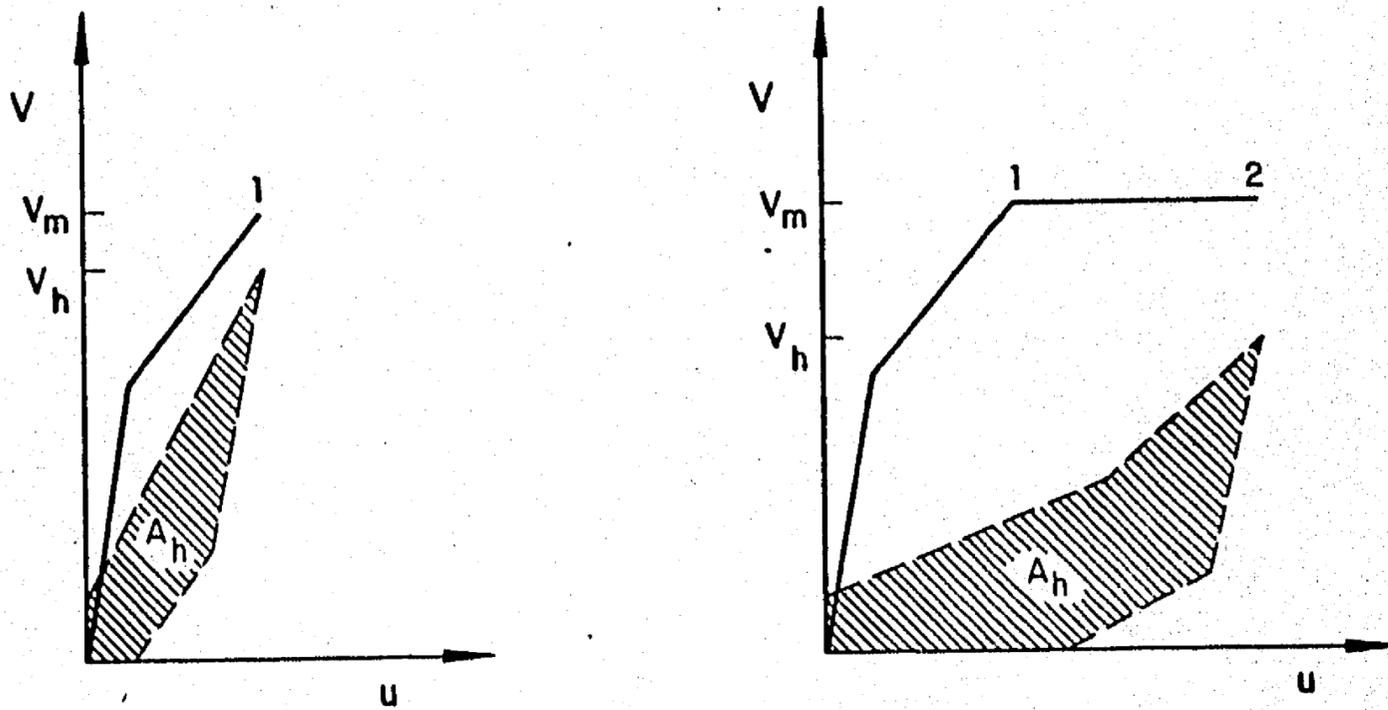
Fig 38. Relación carga - desplazamiento lateral, ciclos posteriores
