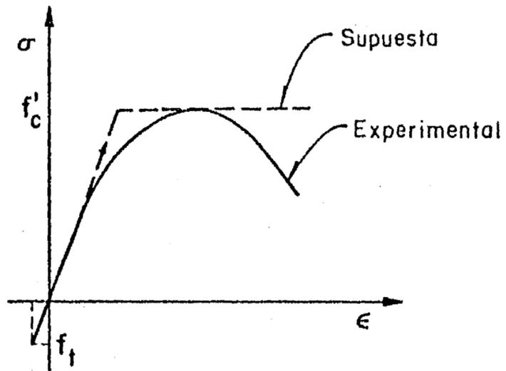
Fig 1. Curva esfuerzo - deformación uniaxial del concreto
