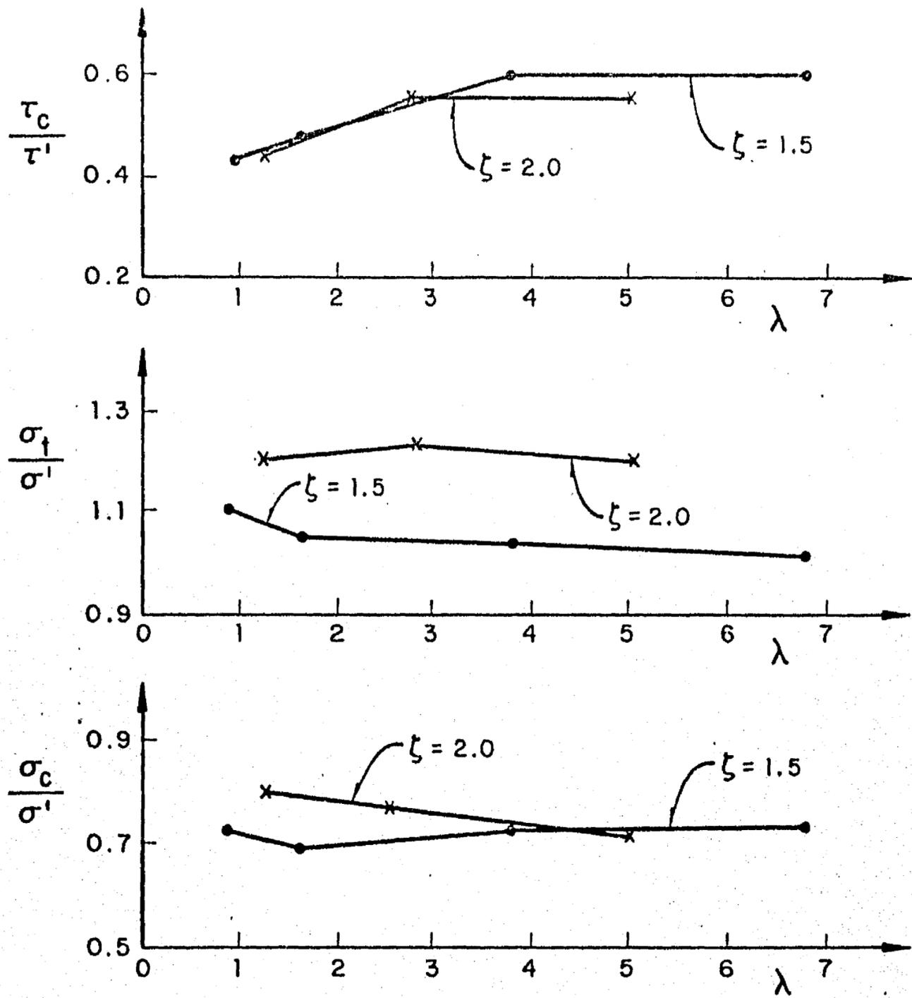
Fig 65. Tableros con relación de aspecto  $\zeta$  mayor que 1. Esfuerzos máximos en las columnas:  $\tau_c$  cortante,  $\sigma_t$  de tensión y  $\sigma_c$  de compresión ( $\tau'$ ,  $\sigma'$  y  $\lambda$  se definen en la fig 57)
