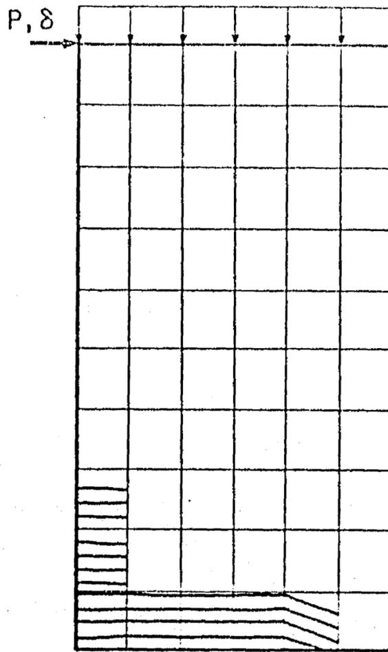
Fig 24. Configuración de agrietamiento obtenida analíticamente para el muro de la fig 22
