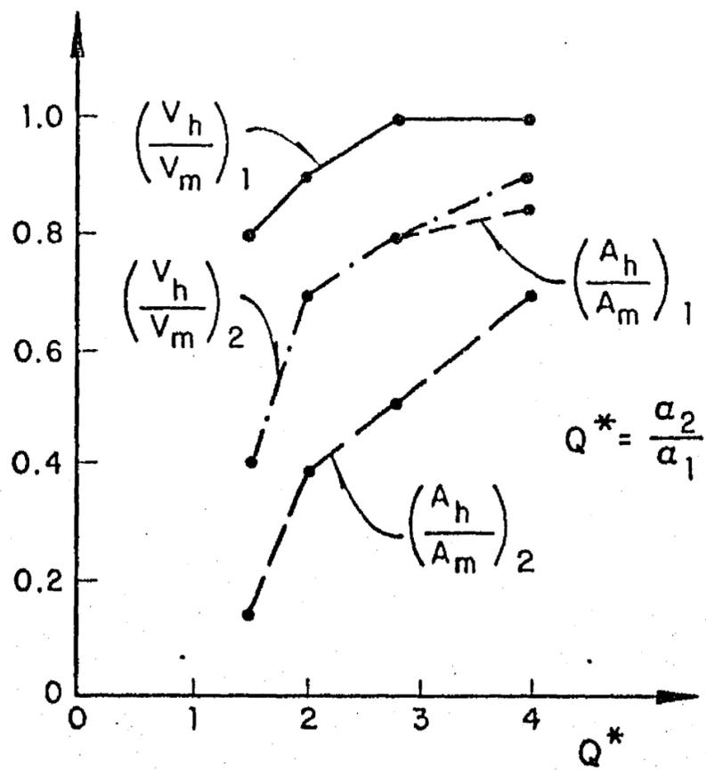
Fig 43. Variación de los parámetros de modelos trilineales que miden el deterioro con la relación  $Q^*$
