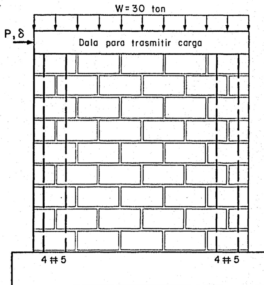
Fig 31. Muro de bloque de concreto con carga vertical (511 en la ref 2)
