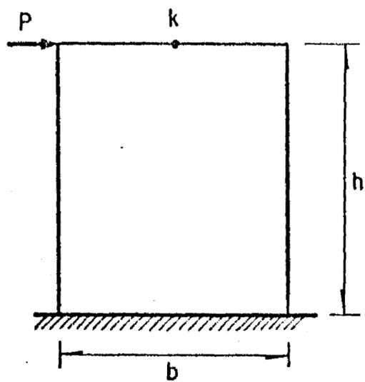
$\delta_{ef}$  = Desplazamiento de k obtenido con elementos finitos
