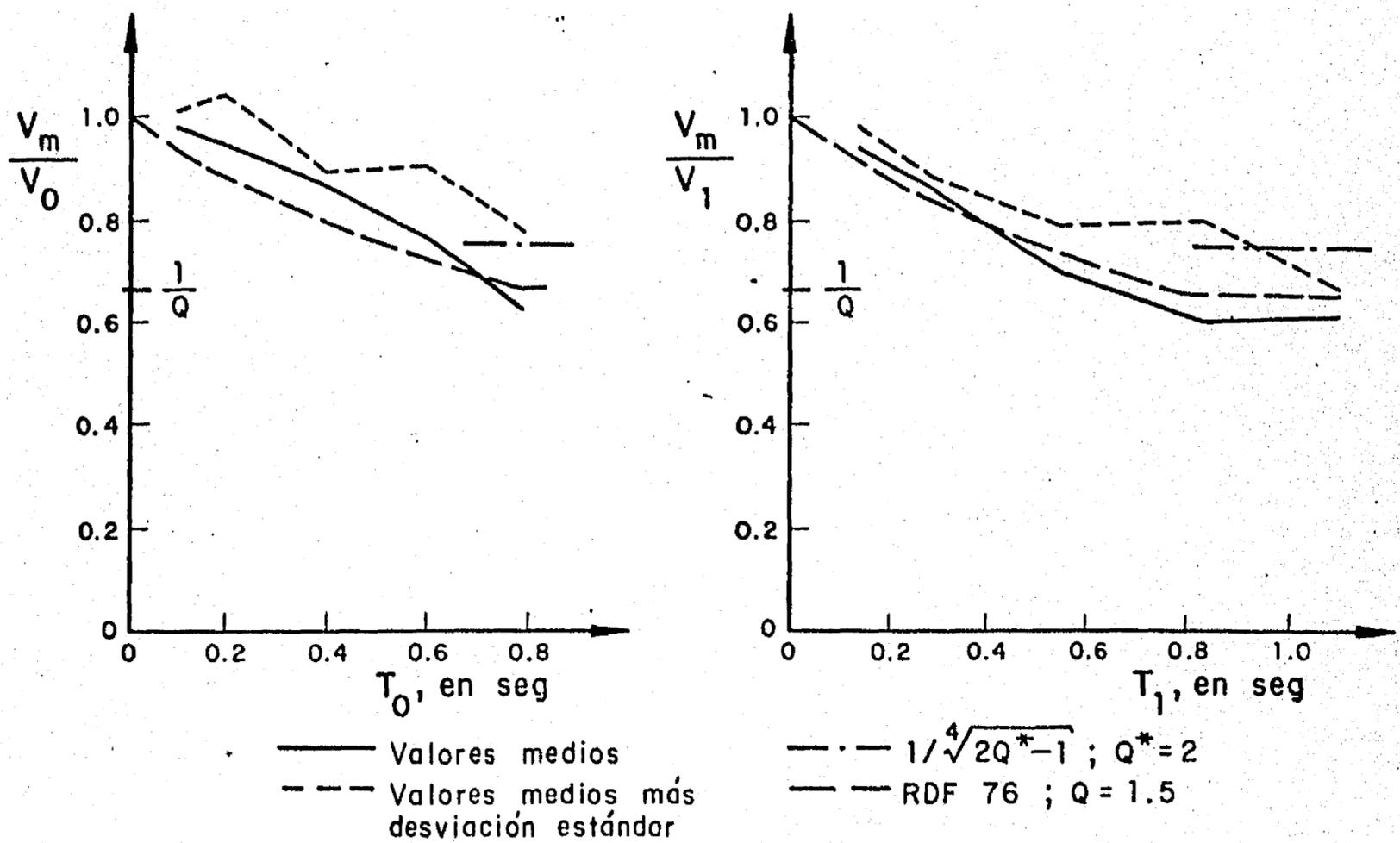
Fig 52. Relaciones entre resistencias inelásticas y elásticas requeridas por el modelo trilineal 3 (fig 41) para temblores en terreno blando
