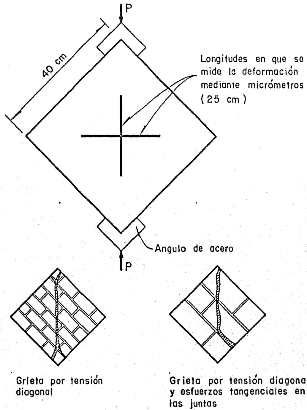
Fig 5. Ensaye de muretes a compresión diagonal (ref 3)
