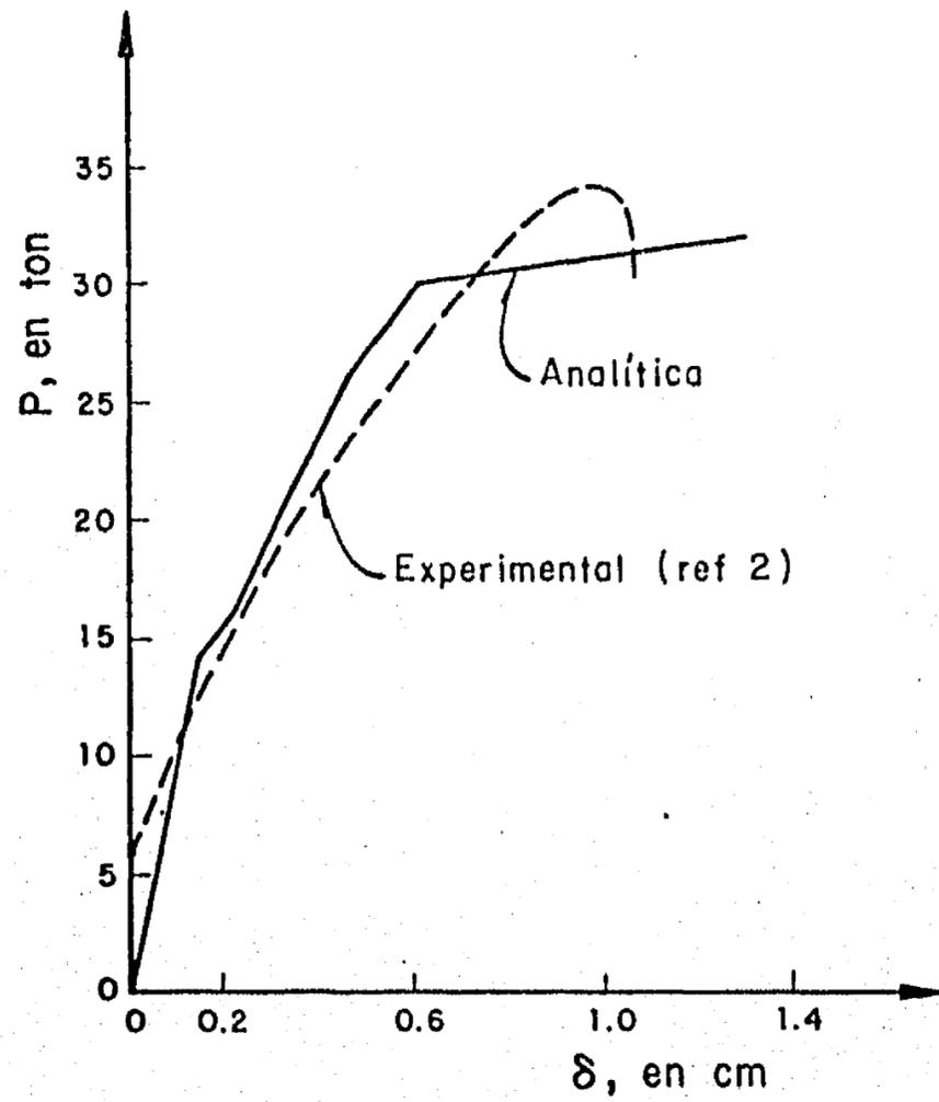
Fig 34. Curvas carga - desplazamiento lateral para el muro de la fig 31
