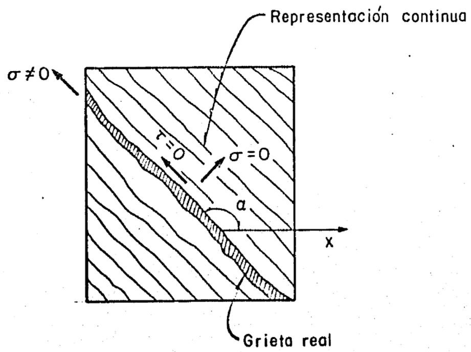
Fig 3. Representación de un material agrietado
