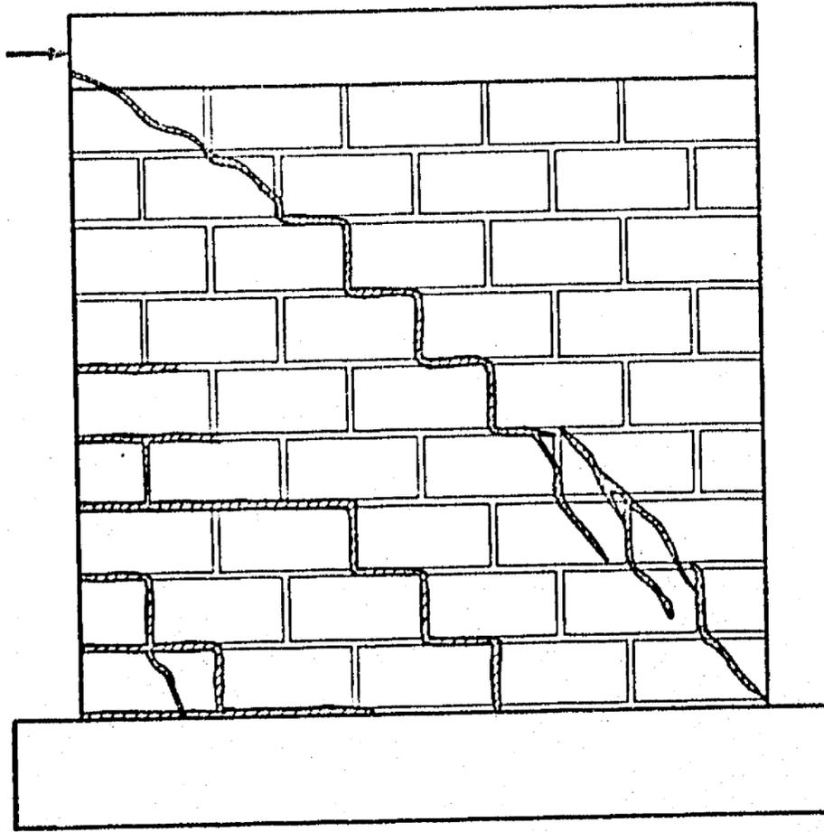
Fig 29. Configuración de agrietamiento experimental del muro de la fig 26
