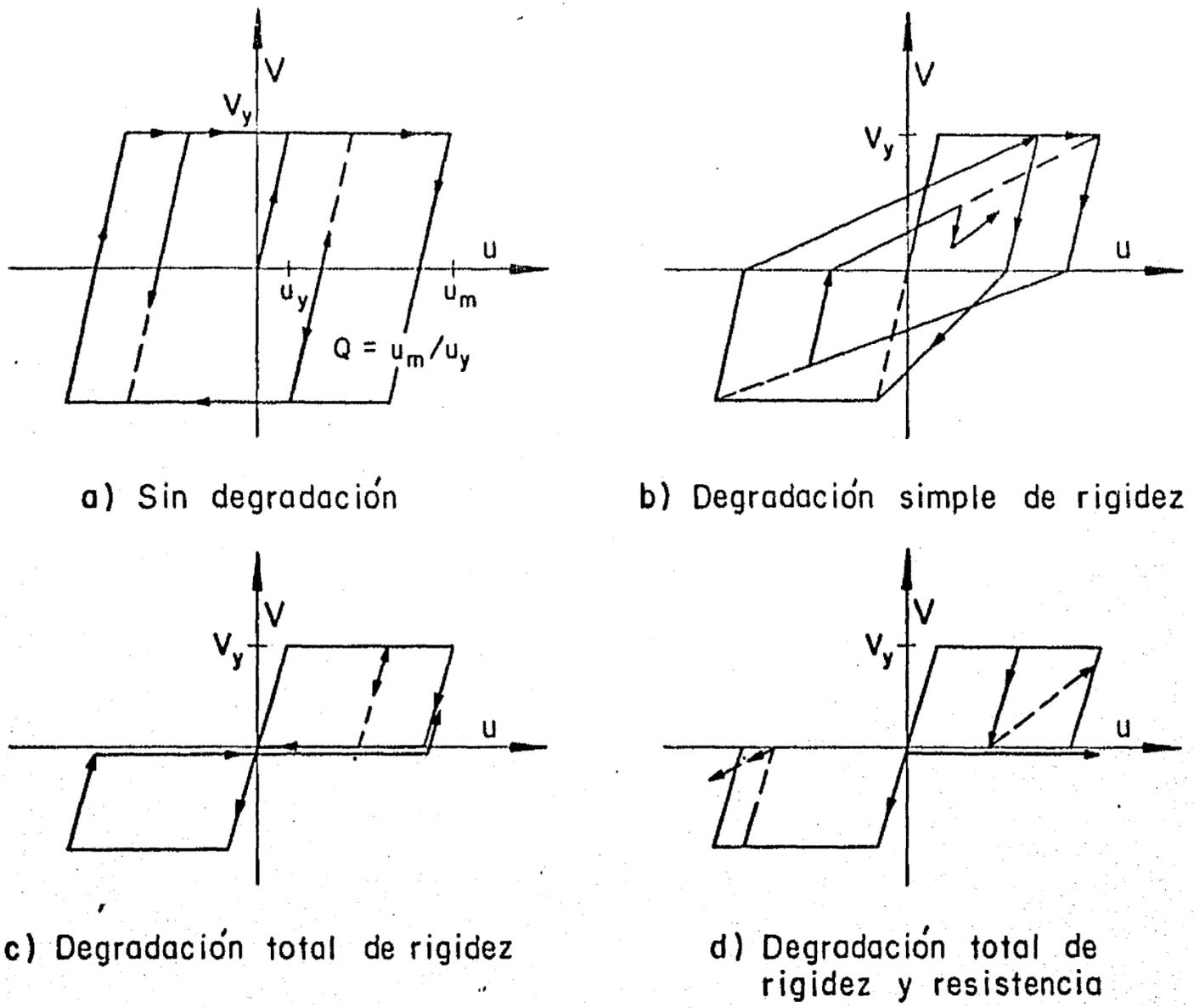
Fig 35. Modelos elastoplásticos
