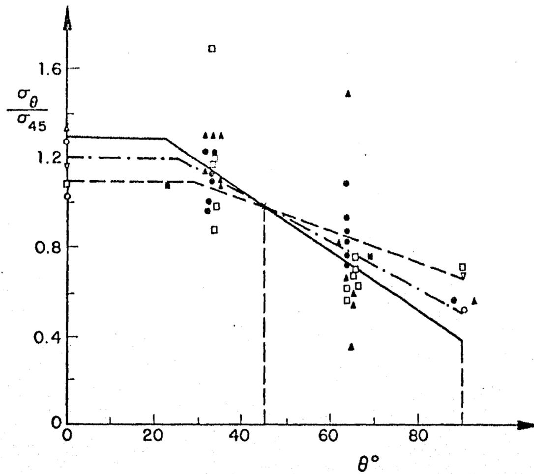
Fig 14. Variación de la resistencia a tensión de la mampostería con el ángulo de aplicación de esfuerzos
