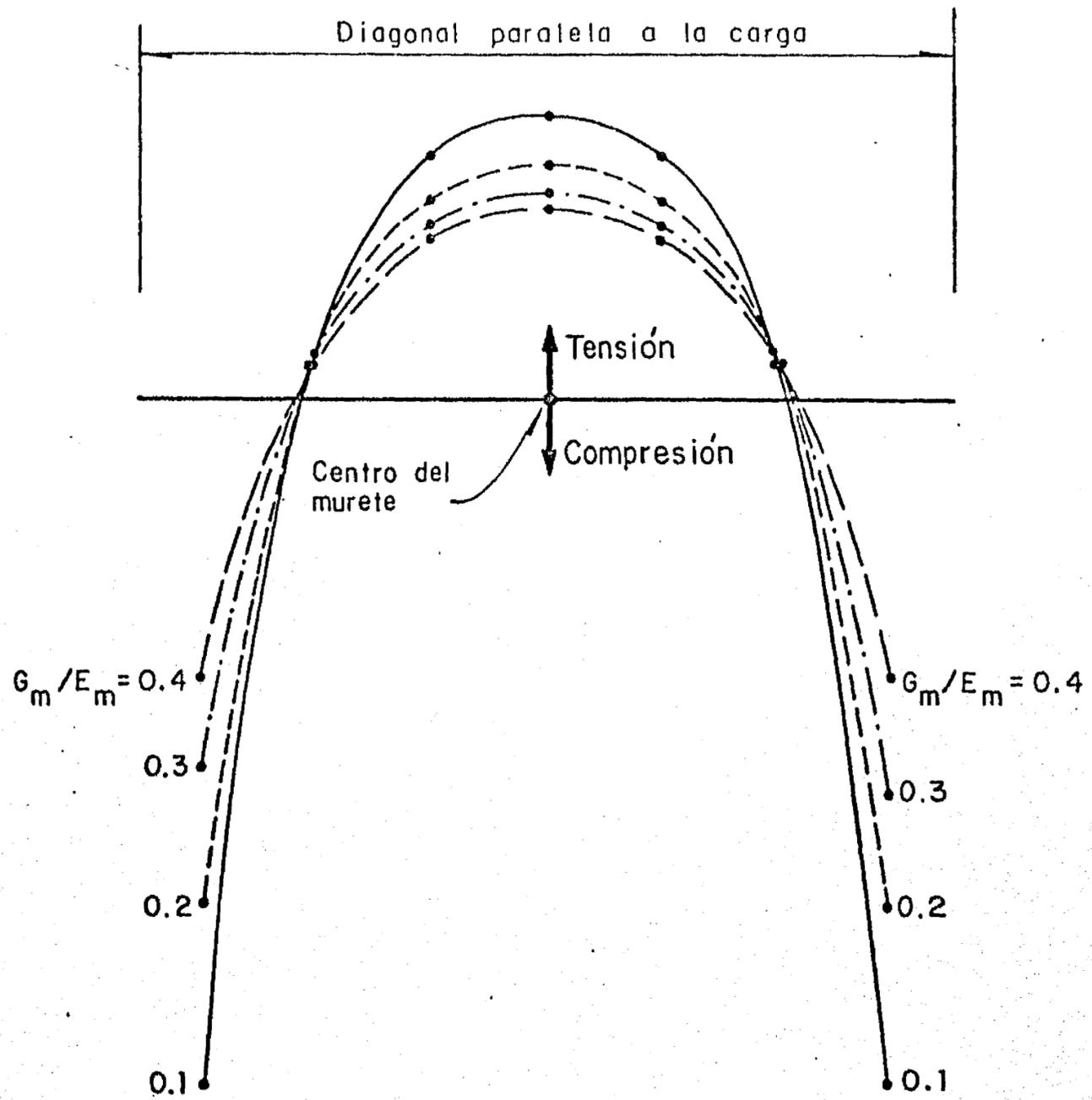
Fig 9. Esfuerzos a lo largo de la diagonal paralela a la carga en un murete a compresión diagonal (ref 7)
