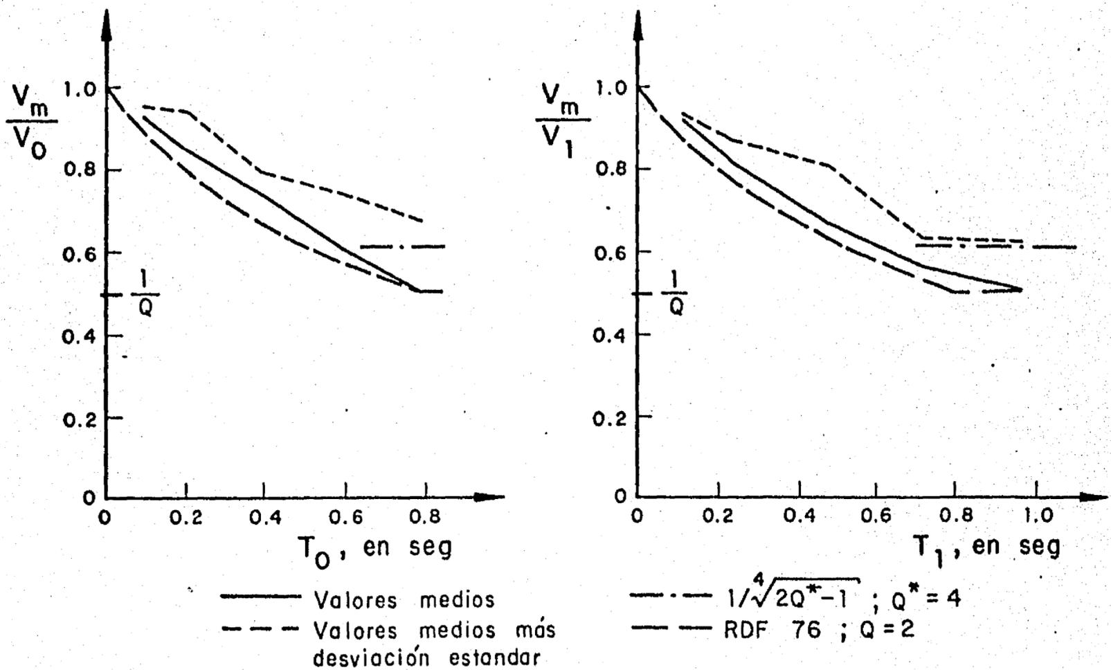
Fig 50. Relaciones entre resistencias inelásticas y elásticas requeridas por el modelo trilineal 1 (fig 39) para temblores en terreno blando
