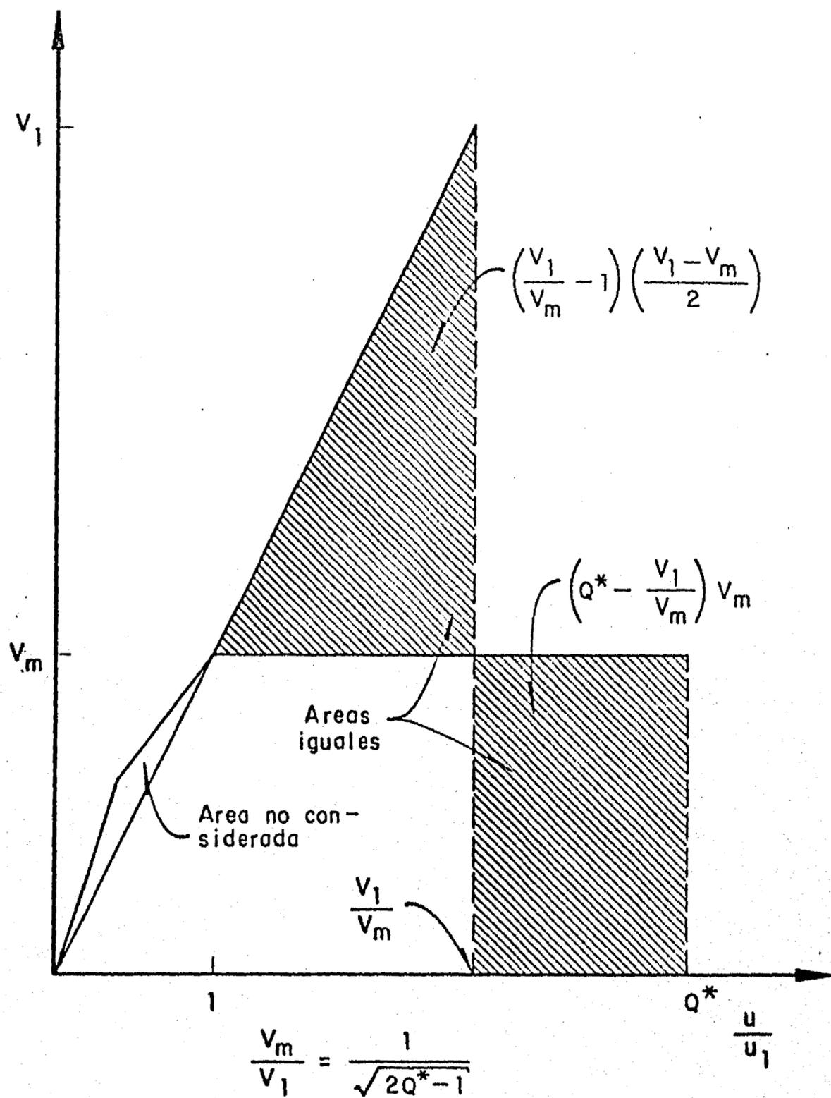
Fig 48. Criterio de igualación de energías para estimar la relación entre respuestas elástica e inelástica para los modelos trilineales
