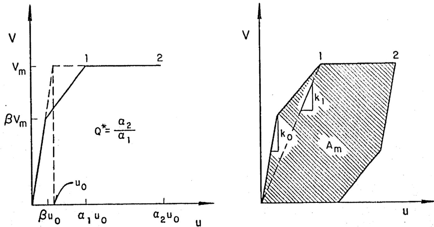
Fig 37. Relación carga - desplazamiento lateral, primer ciclo
