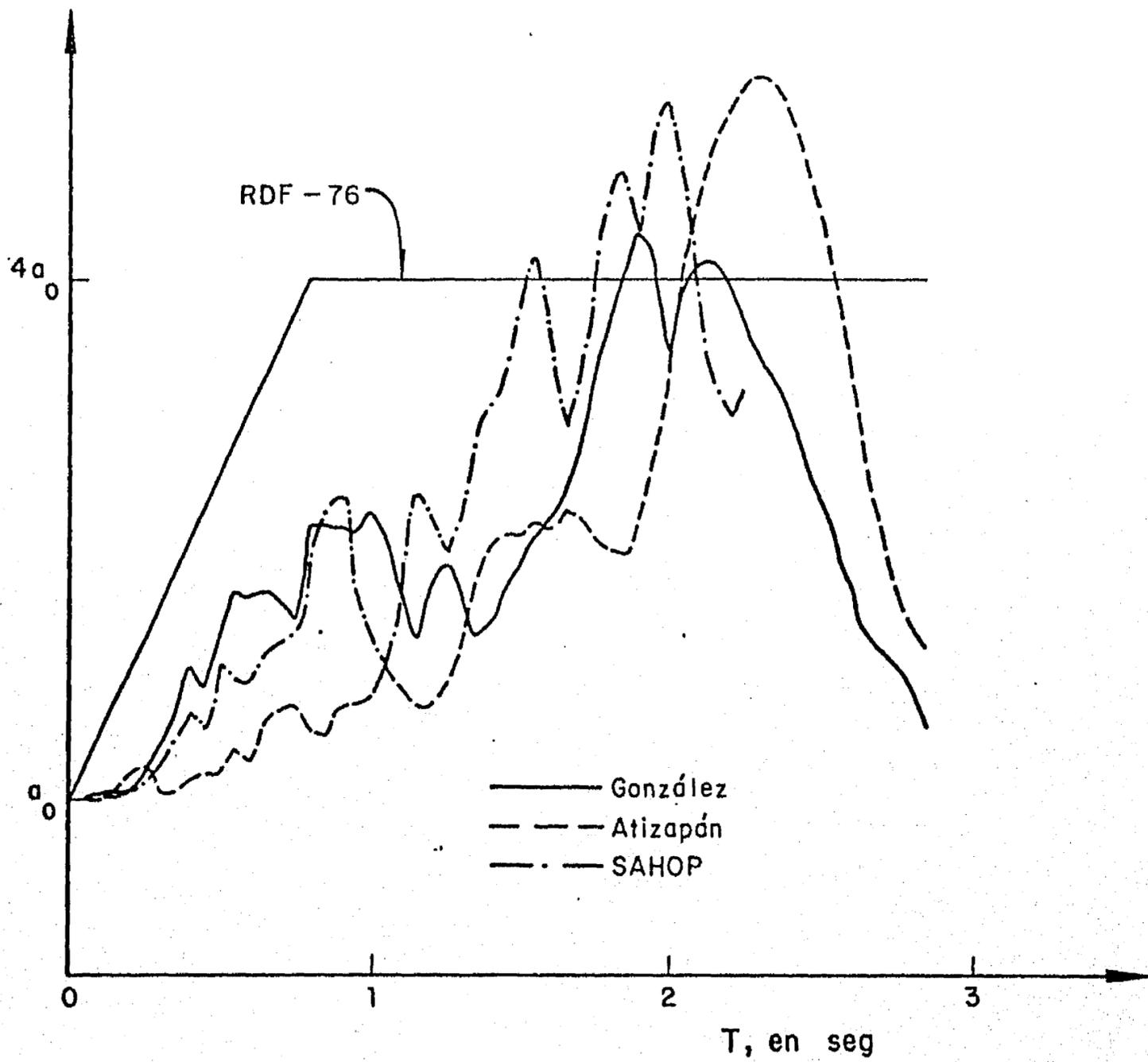
Fig 55. Espectros de pseudoaceleraciones de los temblores en terreno blando, normalizados para que tengan la misma aceleración máxima del terreno
