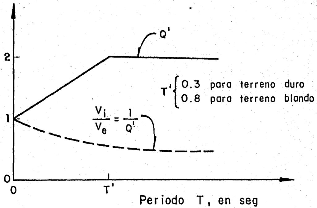
Fig 36. Variación con el periodo de los factores de reducción por ductilidad  $Q'$  prescritos por el reglamento del D. F.
