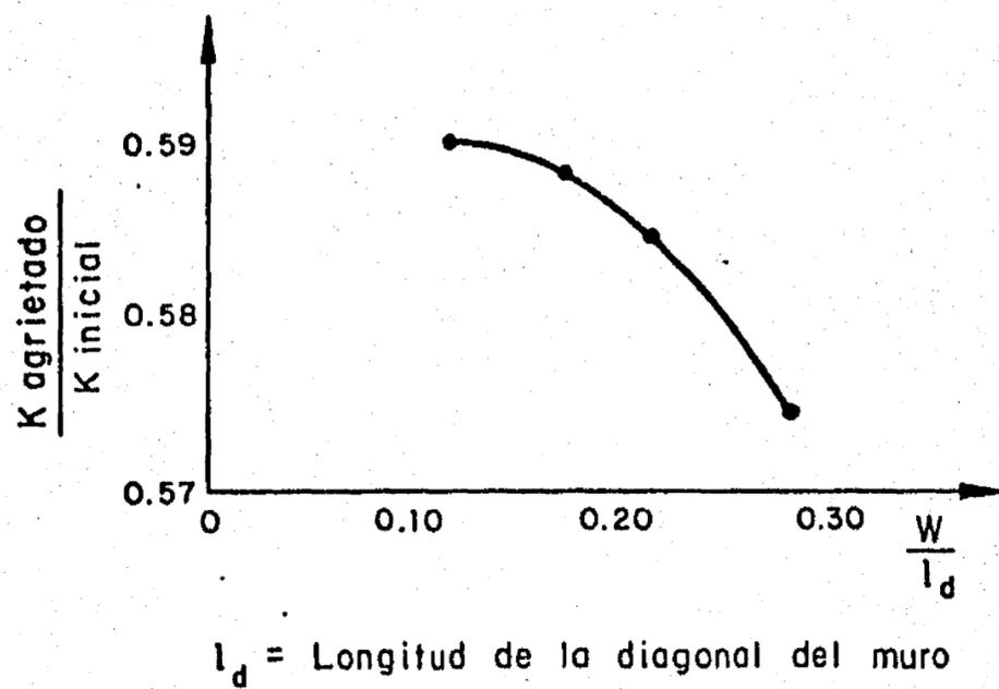
Fig 58. Efecto del ancho de una grieta diagonal en la rigidez lateral de un muro con marco confinante
