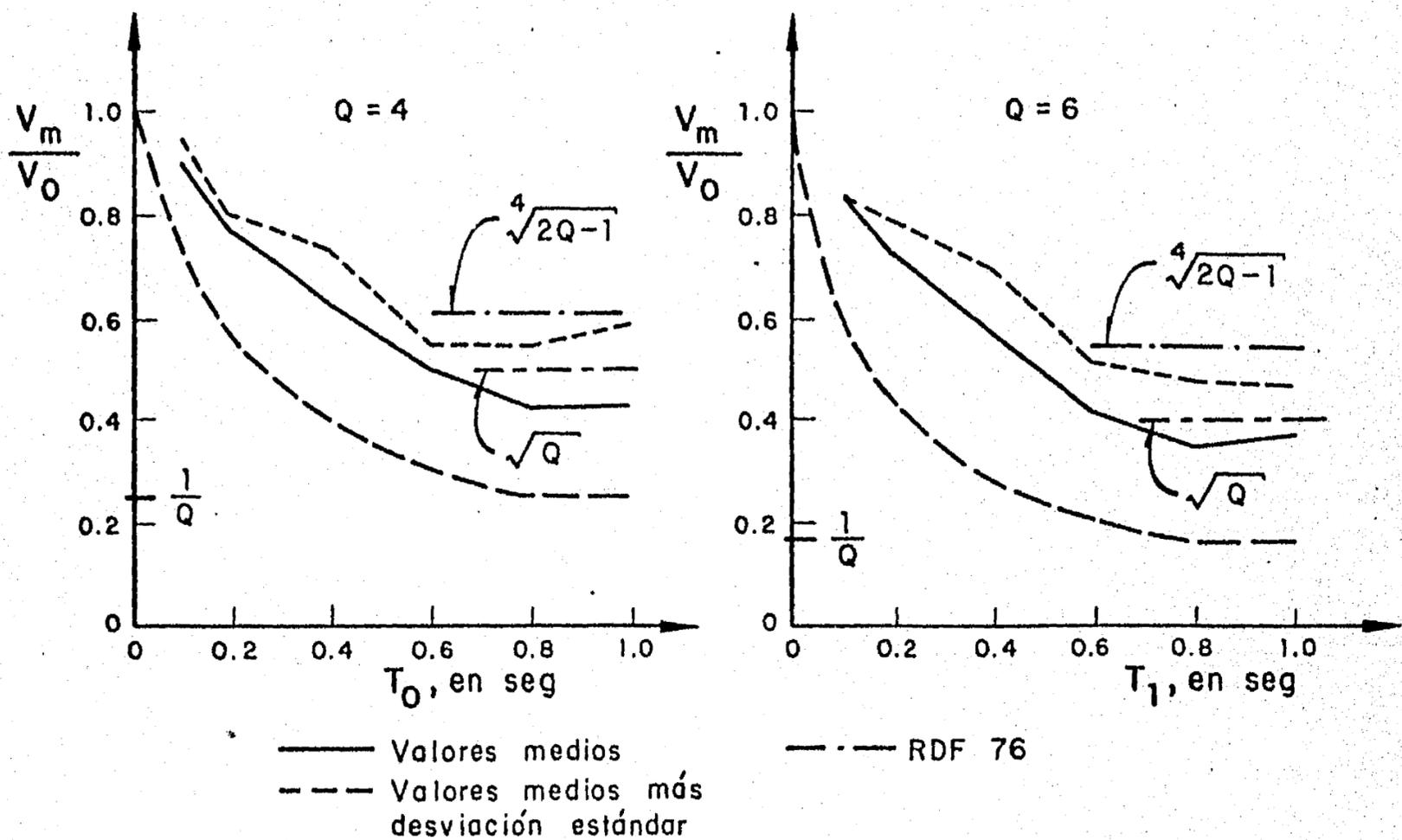
Fig 54. Relaciones entre resistencias inelásticas y elásticas requeridas por modelos elastoplásticos sin degradación (fig 35 a) para temblores en terreno blando
