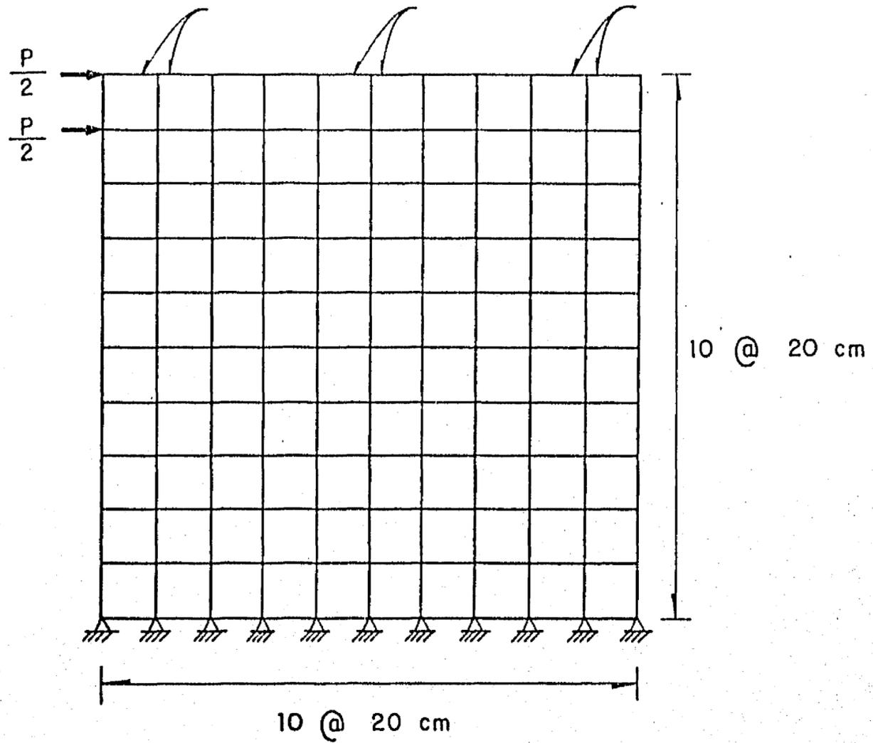
Fig 27. Representación con elementos finitos del muro de la fig 26
