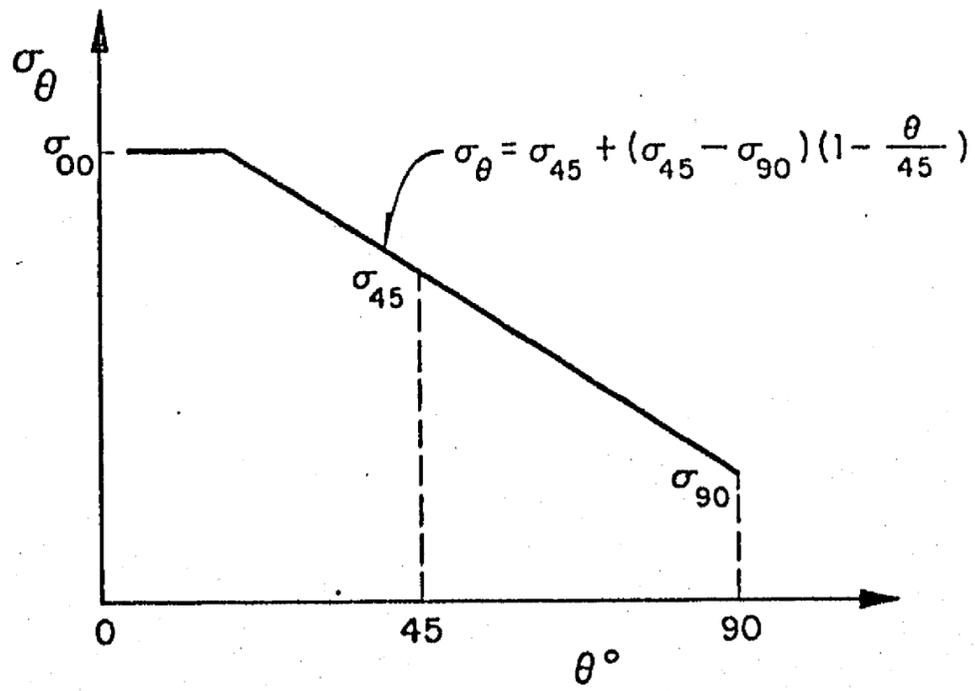
Fig 11. Variación de la resistencia a tensión de la mampostería idealizada como dos tramos rectos
