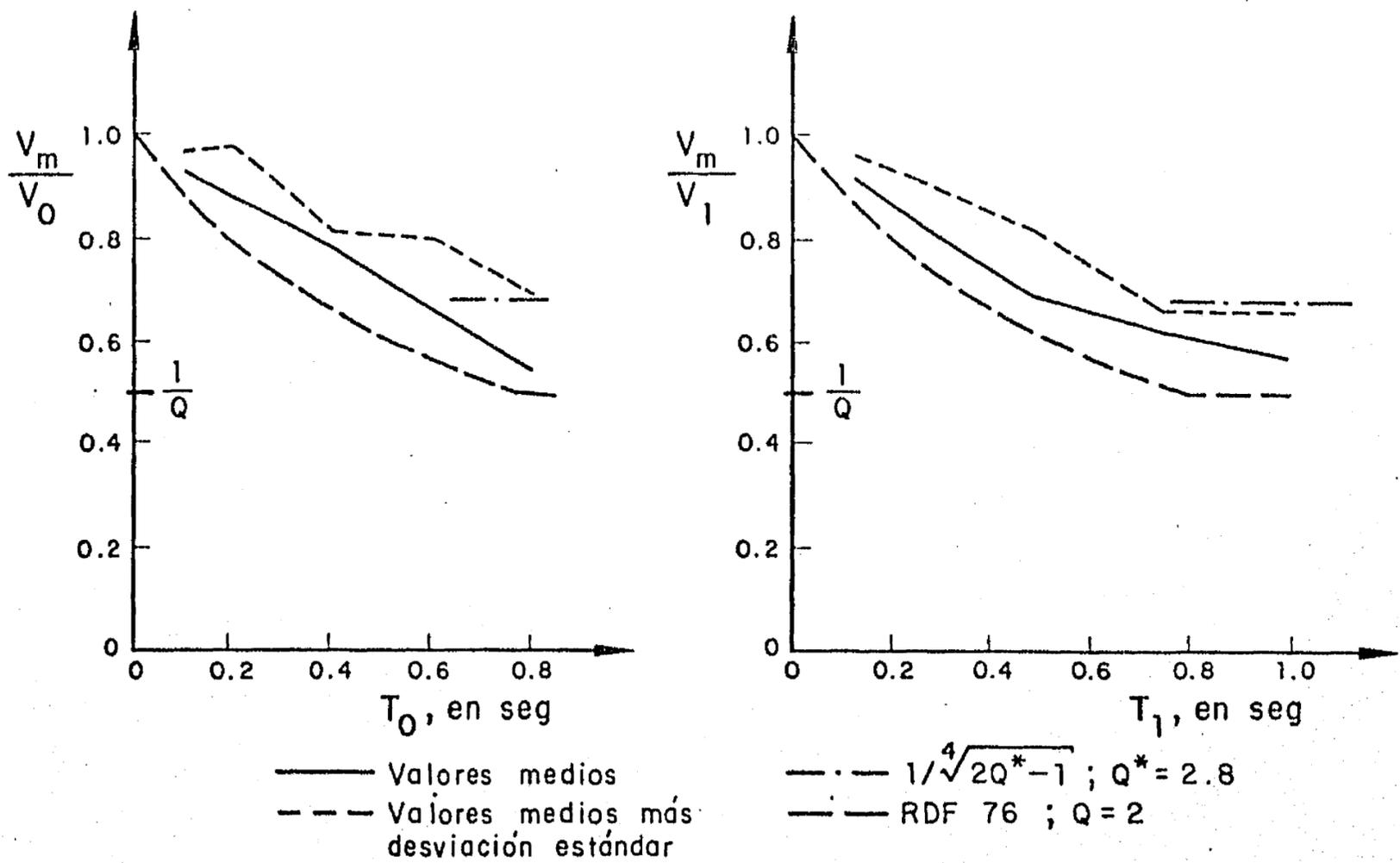
Fig 51. Relaciones entre resistencias inelásticas y elásticas requeridas por el modelo trilineal 2 (fig 40) para temblores en terreno blando
