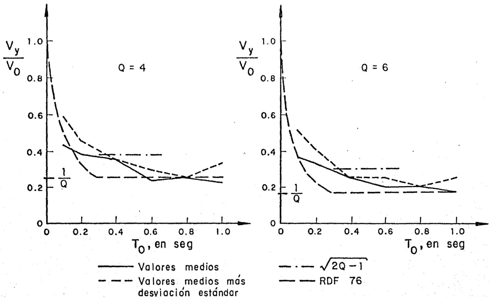
Fig 49. Relaciones entre resistencias inelásticas y elásticas requeridas por modelos elastoplásticos sin degradación (fig 35 a) para temblores en terreno duro
