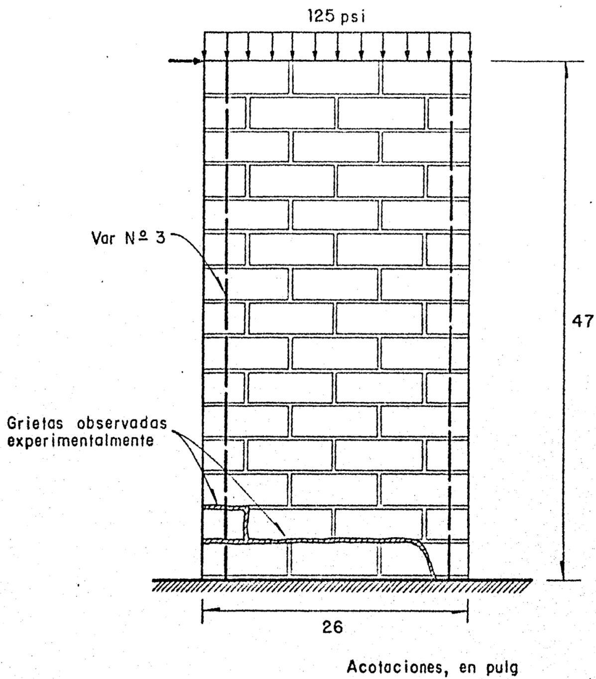
Fig 22. Muro B3 ensayado por Williams (ref 5)
