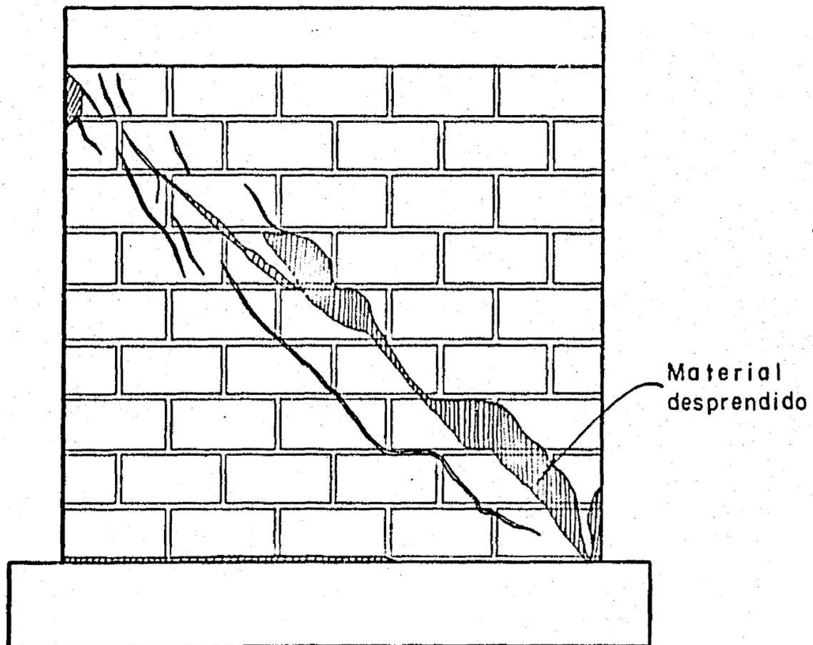
Fig 33. Configuración de falla experimental del muro de la fig 31
