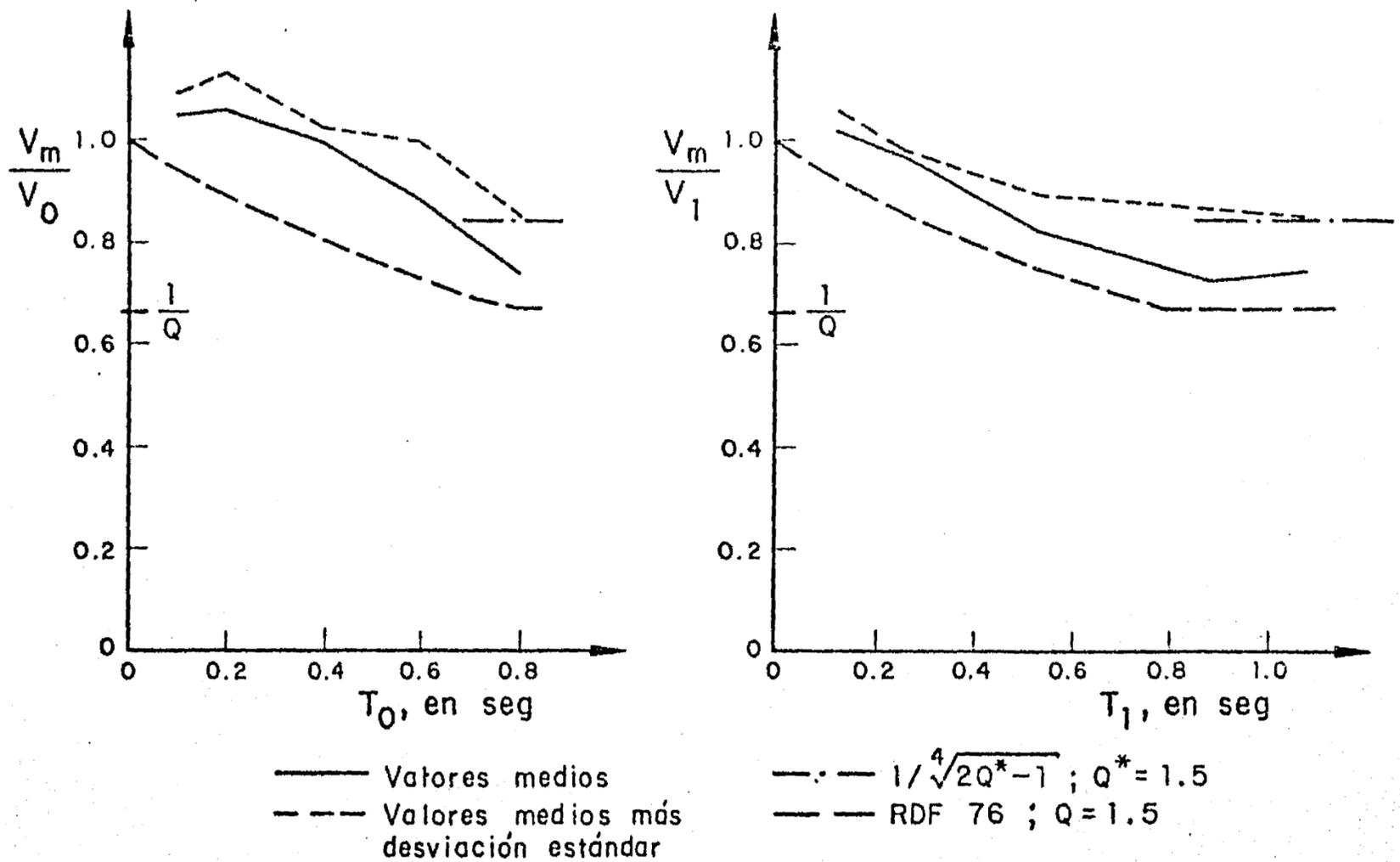
Fig 53. Relaciones entre resistencias inelásticas y elásticas requeridas por el modelo trilineal 4 (fig 42) para temblores en terreno blando
