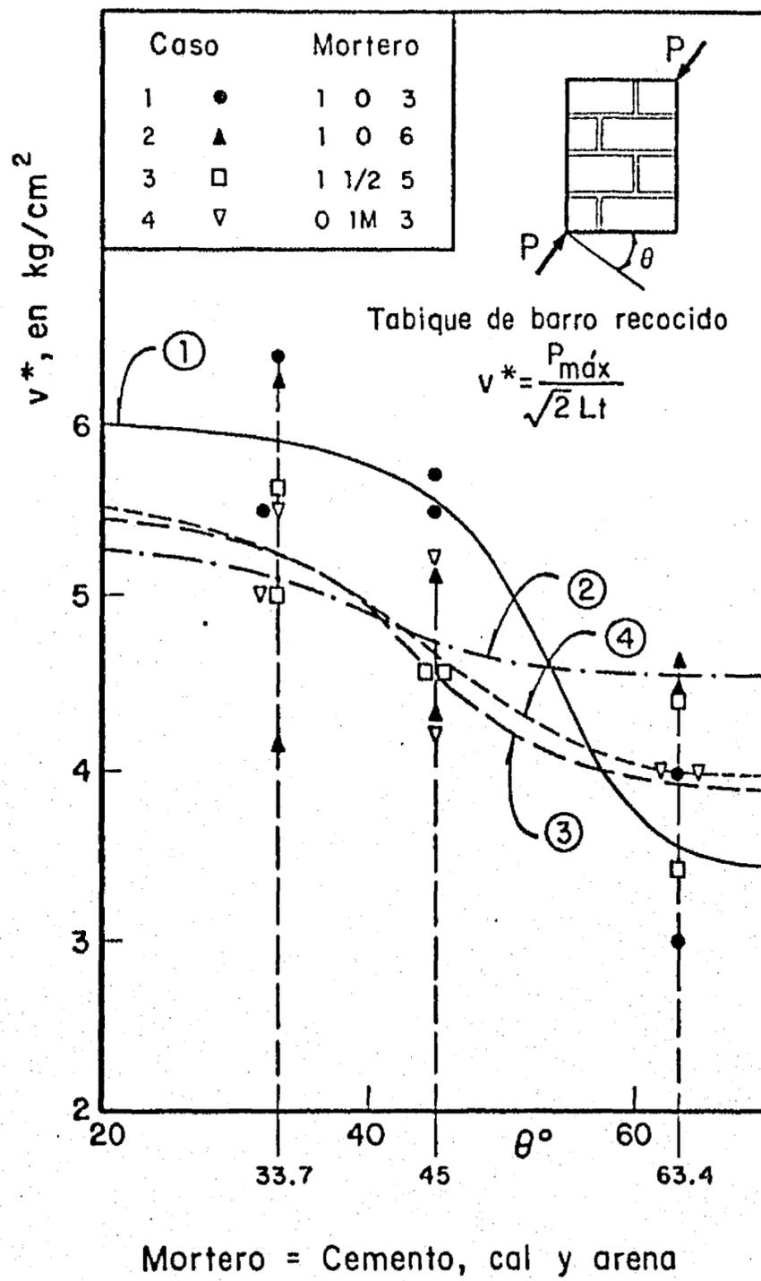
Fig 6. Variación de la resistencia a tensión diagonal en muretes (ref 3)
