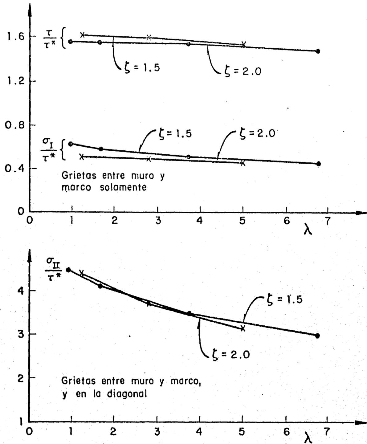
Fig 64. Tableros con relación de aspecto  $\zeta$  mayor que 1. Esfuerzos cortantes  $\tau$  y principales  $\sigma_I$  (tensión) y  $\sigma_{II}$  (compresión) en la sección central del muro.  $\tau^*$  y  $\lambda$  se definen en la fig 57.
