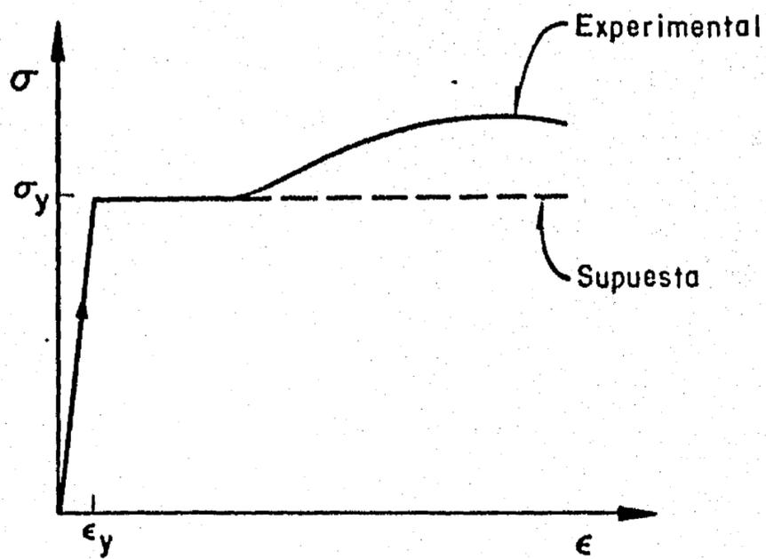
Fig 15. Curva esfuerzo - deformación uniaxial del acero de refuerzo
