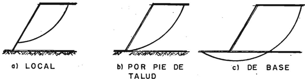
fig. 5.2.- TIPOS DE FALLA EN UN TALUD.
