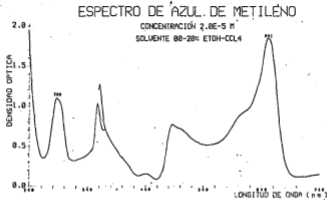
Fig. 14. Espectro de azul de metileno en mezcla 80-20% de etanol-tetracloruro de carbono.
