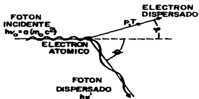
Figura 2.- Diagrama esquemático de la dispersión Compton. h\nu es la energía del fotón incidente, h\nu' la del fotón dispersado en una dirección \theta , T la energía cinética del electrón de retroceso Compton el cual es dispersado en una dirección \phi .
