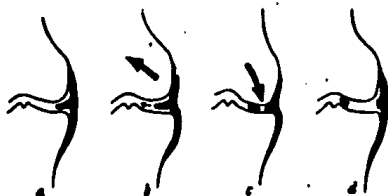
FIG. 9. Mecanismo de la rotura de un menisco (según Konjetzny y Schaer). a) posición normal. b) La posición en flexión, rotación externa y valgo forzado desplaza el menisco al interior de la articulación. c) Una extensión súbita provoca un aplastamiento del menisco entre los cóndilos. d) Desplazamiento del fragmento de menisco desprendido a la escotadura intercondílea.
