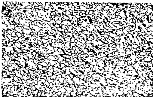
Fotografía 4. Acero con Nb enfriado al aire. Tamaño de grano menor que 8 a 100X, HRB 92.6, ataque con nital al 5%.
