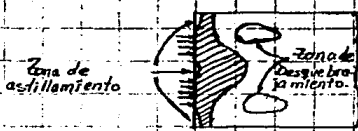
Fig 10.4 Esfuerzos de tensión y zonas de astillamiento y desquebrajamiento.
