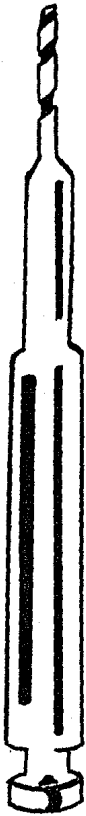
Figura 7-1 Tipo corriente de trépano helicoidal dental (cortesia de Star Dental Manufactura CO.).
