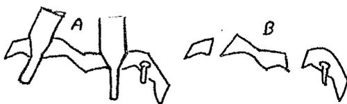
(Fig. V.21) A. El patrón de cera con el pin de metal precioso se retira del troquel. Los pins de plata y níquel se vuelven a colocar dentro de la cera. B, corte transversal del colado individual, una vez disueltos los pins. Los pins paralelos de metal precioso no son disueltos.
