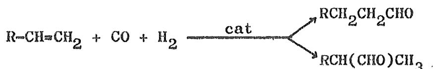
Los productos primarios de la hidroformilación de olefinas son aldehidos, los cuales pueden convertirse rápidamente en productos secundarios tales como alcoholes primarios por subsecuentes reacciones de hidrogenación. Los "alcoholes oxo" constituyen el principal producto comercial de las reacciones oxo, y han encontrado una enorme aplicación de la industria (193).
