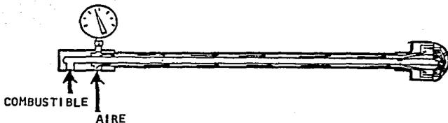
FIG. 2.7 QUEMADOR A DOS FLUIDOS
